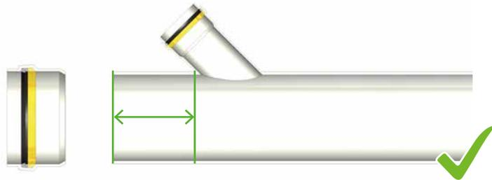
Einfach die Hauptrohrmuffe des Abzweiges abschneiden, anfasen und mit Überschubmuffen einbauen. Fertig ist der nachträglich eingebaute Abzweig!
