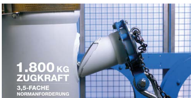
Prüfung am Beispiel POLO-ECO plus Premium DN 400/160/45°
