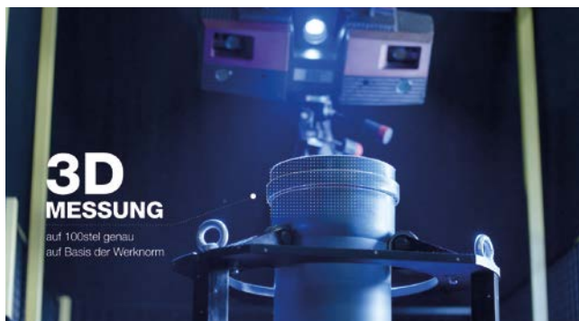
POLO-KAL NG DN 200 bei der Vermessung
