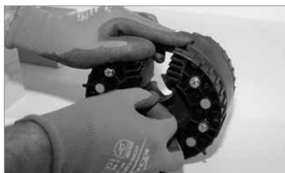
2. Dichtelement aufklappen. Zwiebelringe nach Erfordernis herausziehen, anschneiden und abreißen.
