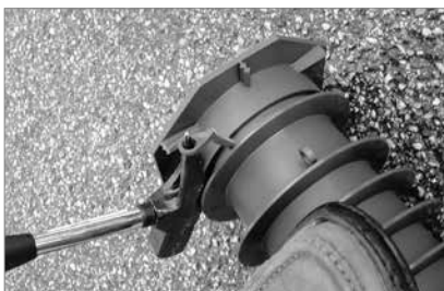
Das Lamellenrohr auf Wandstärken 20 cm oder 25 cm durch Abziehen der Abreißelemente kürzen.
