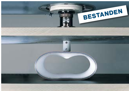
Durchstoßprüfung mit Spitzdorn
