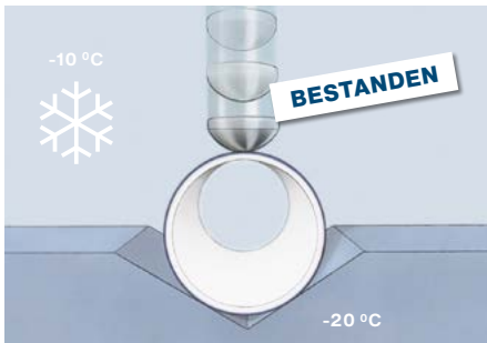
Kälteschlagprüfung, Auszeichnung mit dem Eiskristallzeichen
