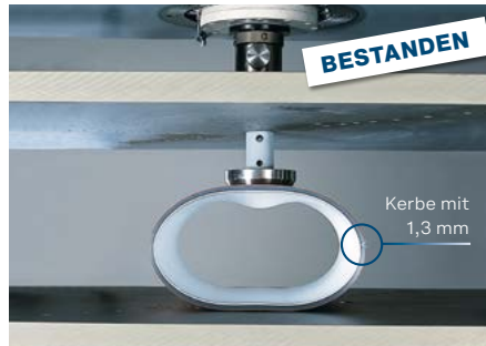
Punktlastprüfung mit seitlicher Einkerbung
