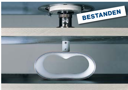
Durchstoßprüfung mit Spitzdorn
