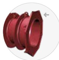
Der **Mauerflansch** ist als Dichtfläche ausgeführt. Damit dringt beim Betonieren keine Zementschlämme ein und das Rohr bleibt innen sauber.
