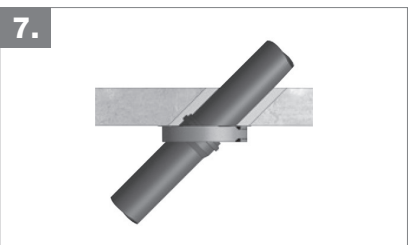
7. Schräg durch Massivdecke über Muffe
