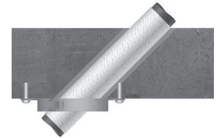
6. Schräg durch Massivdecke über glattes Rohr
